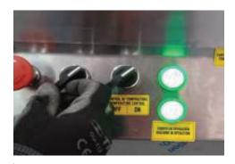
Activate press motor switch OFF/ON
